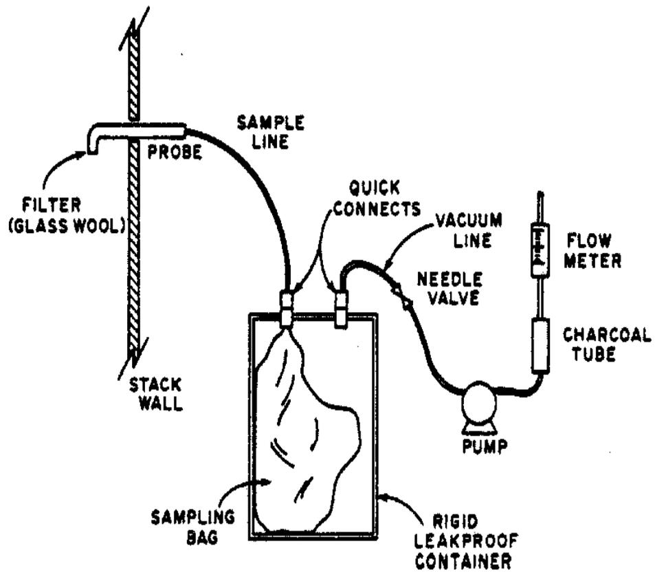
Figure 11. Method 23 sampling train.<sup>56</sup>
