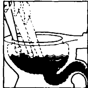
Lower water level by using tool to punch out water. Baje el nivel del agua en el excusado usando el mango de la herramienta.
