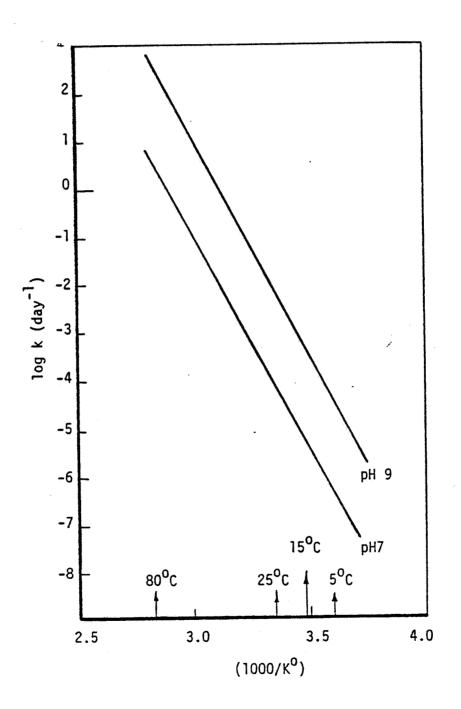
FIGURE 12 SULFOXIDE HYDROLYSIS HALF-LIFE vs pH
